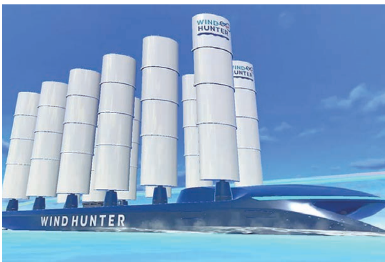
「Wind Hunter」は、帆で風を受けて船を推進させ、その動力を使って海水からグリーン水素を製造・貯蔵・運搬し、陸上にエネルギーとして供給する未来船
