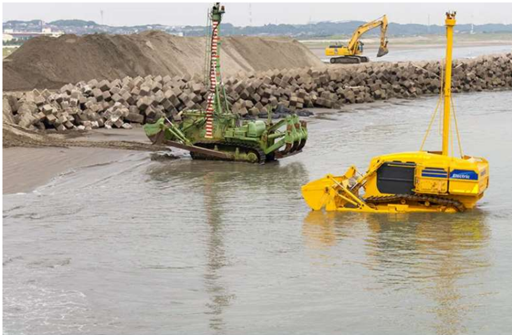
活躍の現場（左：水陸両用ブルドーザー、右：水中施工ロボット）
