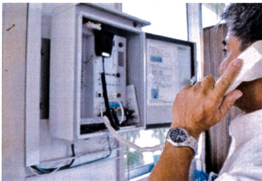
役場へ連絡のため防災行政無線の子局を使用する様子
